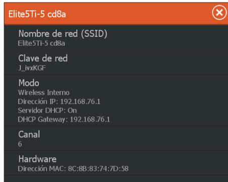
Para ver y cambiar los valores del módulo inalámbrico interno (nombre de red (SSID), clave de red o canal) el modo de Wireless Interno debe ser **Punto de acceso** (Wireless Interno). Para seleccionar una red (punto de acceso) al que conectarse, la conexión inalámbrica interna debe estar en **modo Cliente**.
